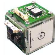
Inertielle Messeinheit zur Erfassung komplexer Bewegungen auf kleinstem Raum
