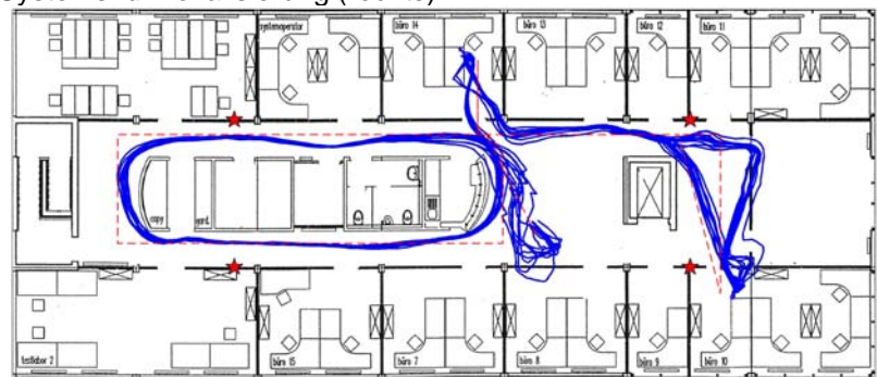
Abb. 2: Zurückgelegter Weg einer Person in einer Büroumgebung. Es sind mehrere Berechnungsdurchläufe dargestellt.
