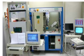
Fig 1: Laserschweißanlage des HSG-IMIT (Einsatz an flexiblen Kunststoffen); 2: Ausschnitt einer siebgedruckten RFID-Antenne
