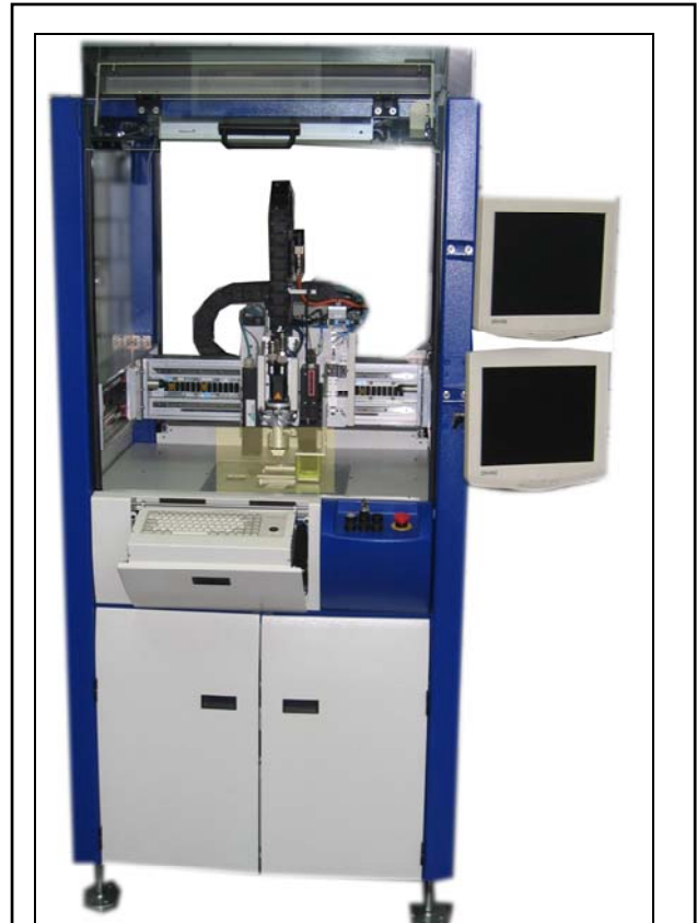
FLB 1: Bestückungsanlage für Klein- und Mittelserienfertigung
