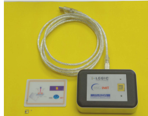
Fig 1: MiniPrime-Datenträger, Transceiver 2 und Smart Cards in ISO-Format; 2: Mikrosystemtechnisch strukturierte Antenne
